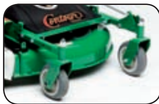
Pivohjul Gør det lettere at manøvrere maskinen. Hjulene kan fastlåses.
